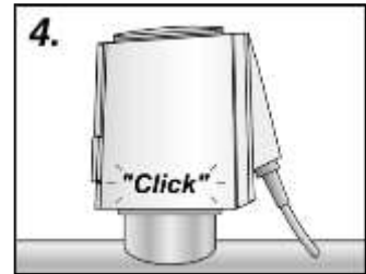
4. OEM ställdonet trycks ned över adaptern med ett "klickljud" för hand
